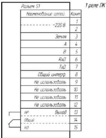
Рис. Б.3. Наименование цепей, типовое подключение внешних устройств и расположение контактов реле разъема S1 Контроллера (исполнение I): а) без токового выхода; б) с токовым выходом
